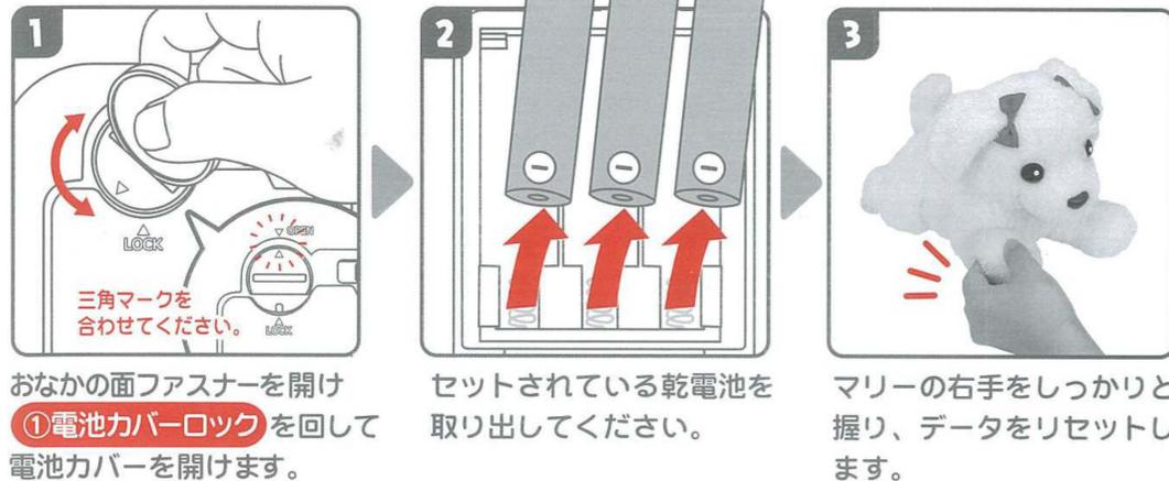
※「①電池カバーロック」を回すときは中央の溝に500円硬貨などのコインを差し込んで、電池ボックスの▼OPENの三角マークと「①電池カバーロック」の三角マークが向かい合うよう180度回してください。
