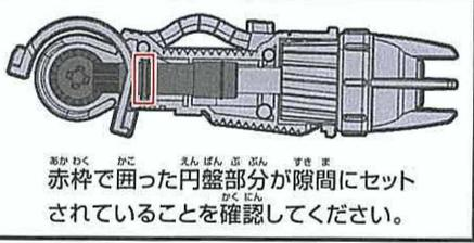
赤枠で囲った円盤部分が隙間にセットされていることを確認してください。
