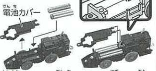
写真のように電池カバーを外した後、単4形乾電池2本を⊕⊖を間違えないように正しくセットしてください。サウンド「プルルルル〜」が鳴ります。その後、電池カバーを図のように取り付けます。※電池を交換すると、今までの走行距離が「0」(リセット状態)に戻ります。
