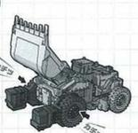
前輪部を押し込みジョイントで固定します。
