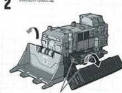
クローラー前部のジョイントを外し、クローラー部を倒します。
