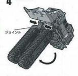
クローラー部を倒し、クローラー付け根部をジョイントで固定します。
