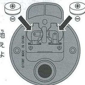
③電池カバーのツメを先に合わせて取り付け、ドライバーでビスを締めます。
