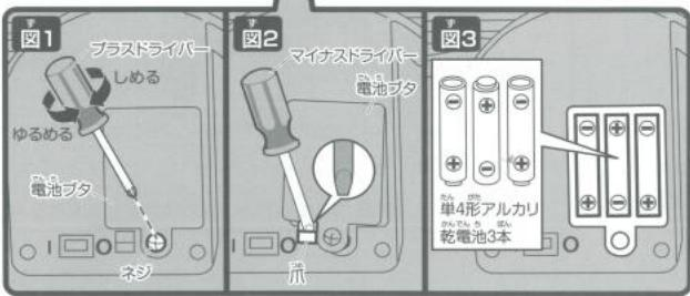
① プラスドライバーで本体底面の電池ブタのネジをゆるめます。図1
