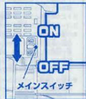
※この際、ビビビビという警告音がする時は、左図の①～④のマークの付いている所が外れています。①～④のマークの取り付けを確認して、メインスイッチを入れなおしてください。
