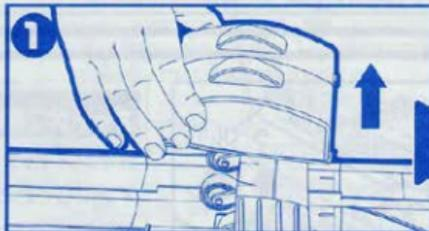
メインスイッチを必ず「OFF」にしてから、クリアドームを外します。
