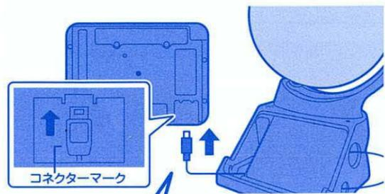
コネクターを台座のくぼみに収納し、グローブパッドがガタつかないようにセットします。
