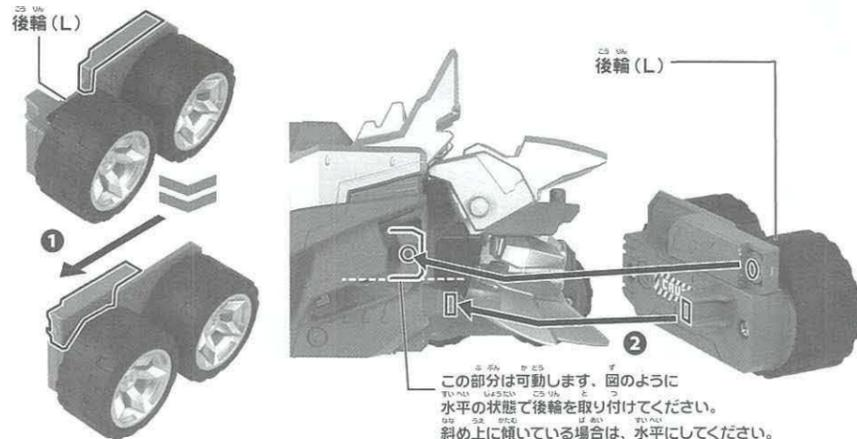
この部分は可動します。図のように水平の状態の後輪を取り付けてください。斜め上に傾いている場合は、水平にしてください。
