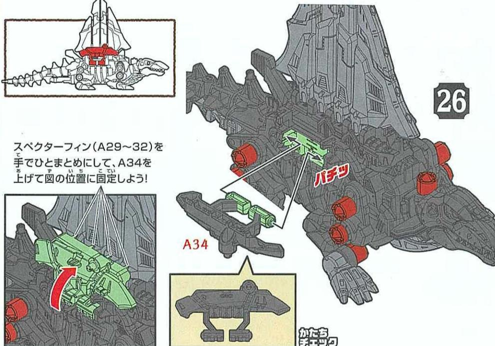
スペクターフィン(A29~32)を手でひとまとめにして、A34を上げて図の位置に固定しよう!
