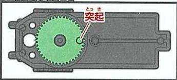
ギアの突起が図の位置にくるように取り付けよう。
