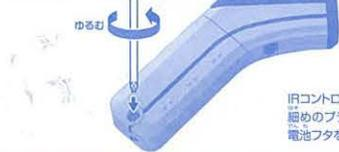
IRコントローラー裏側のネジを、細めのプラスドライバーでゆるめて、電池フタを取り外してください。
