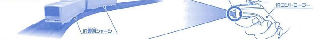
走行する時はIRコントローラーの赤外線送信部をIR専用シャーシに向けてください。赤外線到達距離は約1.7mです。赤外線送信部がIR専用シャーシに正しく向いていないと赤外線到達距離が短くなる場合があります。※遊が状況によって赤外線の届く距離や範囲が多少異なります。※IRコントローラーとIR専用シャーシの間に障害物があると、正常に操作できない場合があります。※取り扱い説明書(本紙)の表紙に記載されている「お願い」も併せてご覧ください。
