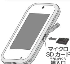
本体右側面のカバーを外し、マイクロSDカードを挿入口に図のような向きでカチッというまで押し込んで装着してください。再度マイクロSDカードをカチッと音がするまで押し込むと取り出することができます。その後、マイクロSDカードが飛び出さないよう、指の腹で押さえながら取り出してください。挿入する向きに注意してください。
