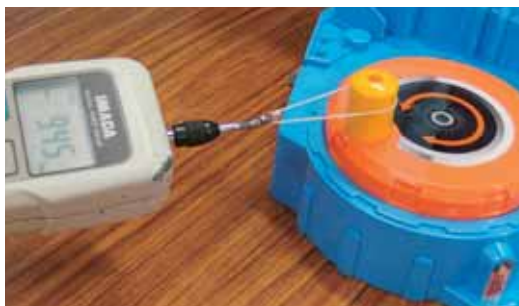
商品の強度検査 (「トミカ」では500を超える安全品質検査項目を確認)
